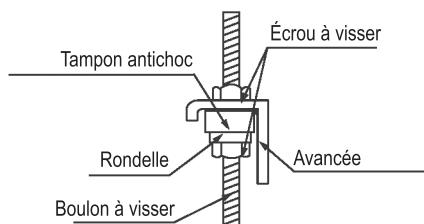
2.3.3 Vissez les écrous pour suspendre l'appareil
