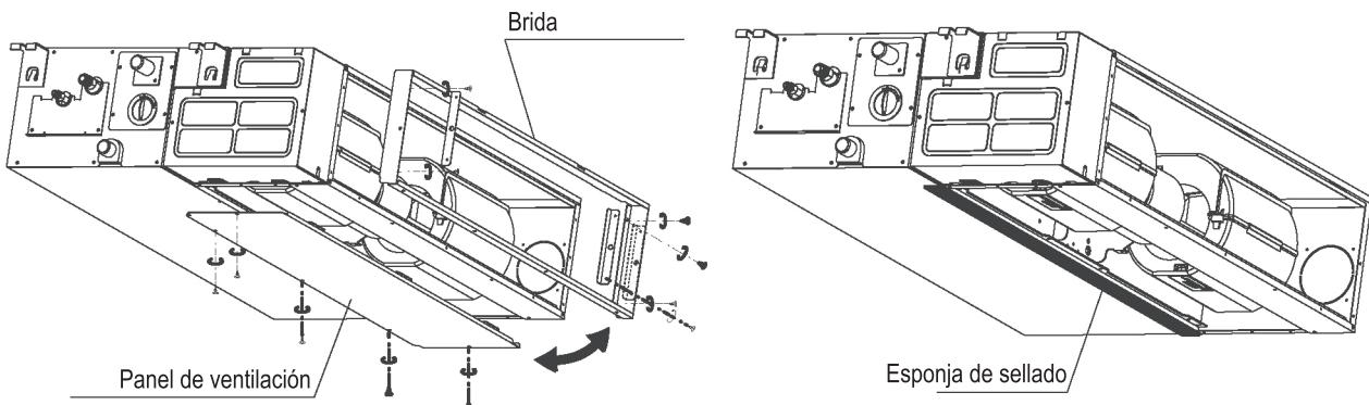
3. Conecte el filtro de aire a la brida según se muestra en el diagrama.
