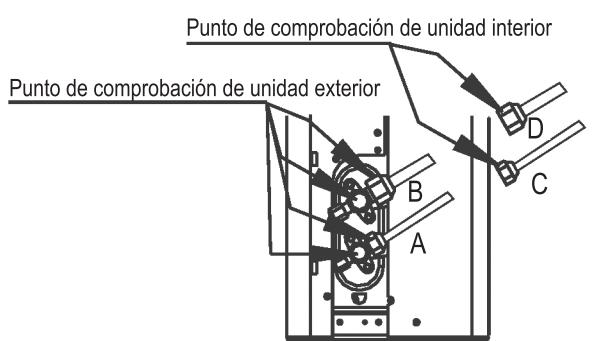
A: Válvula de detención de presión baja
