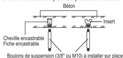
2.2.3 Installez les boulons de suspension (utilisez 4 boulons de suspension de diamètre 3/8" ou M10) en fonction du type de plafond.
